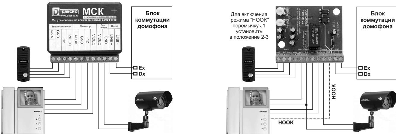
вход сигнала HOOK. Общий провод сигнального кабеля подъездного видео нужно подключать к любой другой клемме GND (2 или 6) в такой конфигурации. Данная схема подключения действительна только для модулей сопряжения МСК версии 2d и выше.
