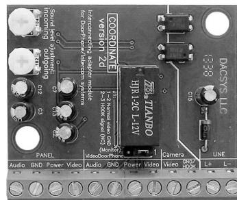
При регулировке не используйте усилие, винт регулятора должен вращаться легко на угол около 300°. Для вращения рекомендуется использовать небольшую отвертку. После настройки уровней соберите модуль обратно и уберите в предназначеннное для него место.
