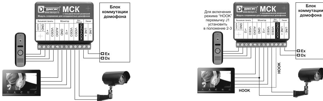
При подключении по правой схеме не забудьте перевести перемычку J1 в положение 2-3, при этом назначение клеммы 10 переключится из GND во вход сигнала HOOK. Общий провод сигнального кабеля подъездного видео нужно подключать к любой другой клемме GND (2 или 6) в такой конфигурации. **Если Ваш видеодомофон не оборудован выходом сигнала HOOK - не переставляйте эту перемычку.**
