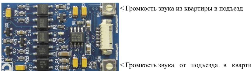
При регулировке не используйте усилие, винт регулятора должен вращаться легко на угол около 300°. Для вращения рекомендуется использовать небольшую отвертку.
