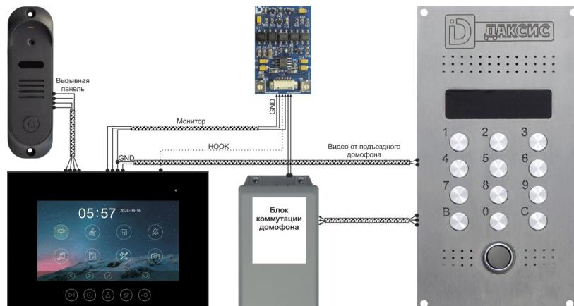
Подключите модуль сопряжения к остальному оборудованию, как показано на схеме. Если выход сигнала "HOOK" в Вашем видеодомофоне не предусмотрен, зелёный провод никуда не подключайтесь.
