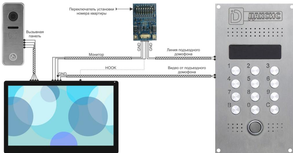
Подключите модуль сопряжения к остальному оборудованию, как показано на схеме. Если выход сигнала "HOOK" в Вашем видеодомофоне не предусмотрен - зелёный провод никуда не подключайте.
