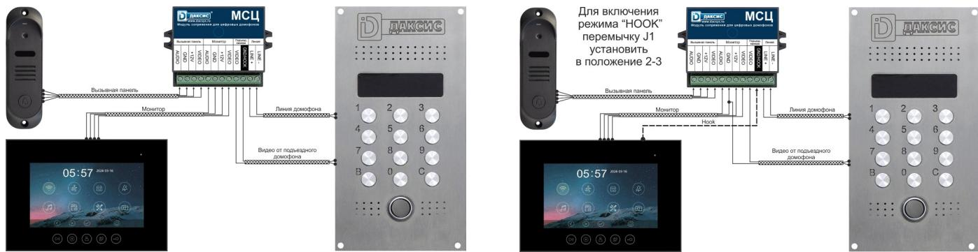
При подключении по правой схеме, не забудьте перевести перемычку J1 в положение 2-3, при этом назначение клеммы 10 переключится из GND во вход сигнала HOOK. Общий провод сигнального кабеля подъездного видео нужно подключать к любой другой клемме GND (2 или 6) в такой конфигурации. Данная схема подключения действительна только для модулей сопряжения МСЦ версии 1e и выше.
