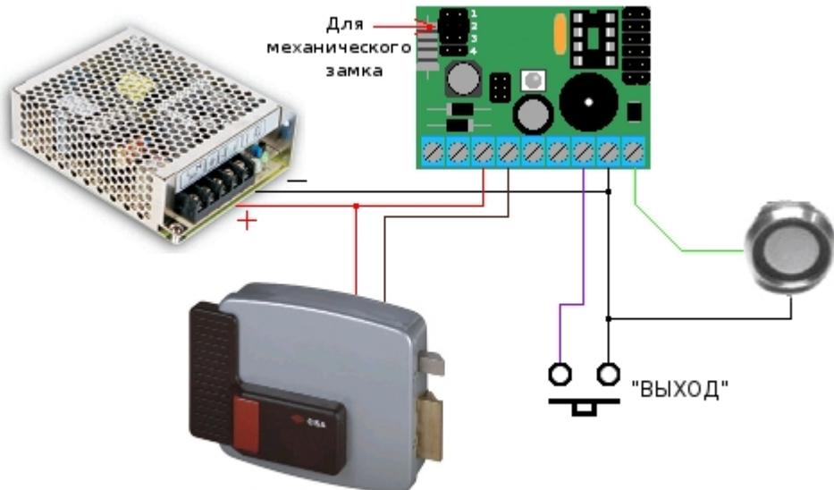
Здесь приведен пример подключения мощного электромеханического замка с рабочим напряжением 12 вольт. Перемычка устанавливается только для того, что бы контроллер правильно работал с электромеханическим замком (то есть, подавал напряжение кратковременно для разблокирования двери). Если требуется обычная, "электромагнитная" логика работы - тогда перемычку устанавливать не нужно.
